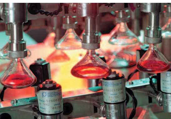
Bild 3: Auf einer Schüttelbank werden Proben für die Analyse der Sauerstoffisotope im Massenspektrometer präpariert.
